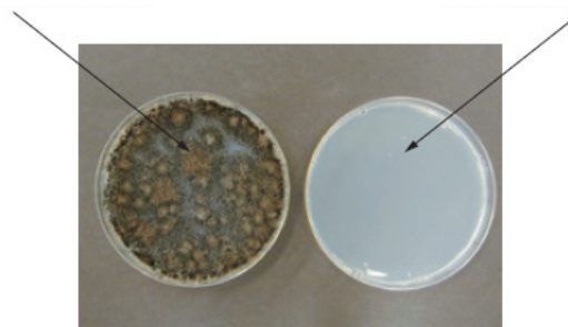
Sammenligning af bakterievækst og mug på ventilator overflader
